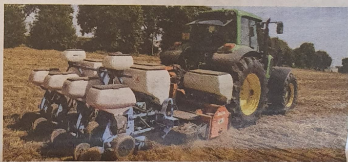
Ce matériel venu de Suisse est conçu pour semer du maïs après pâture, il travaille un peu plus large qu'en strip-till et mélange plus la terre.
