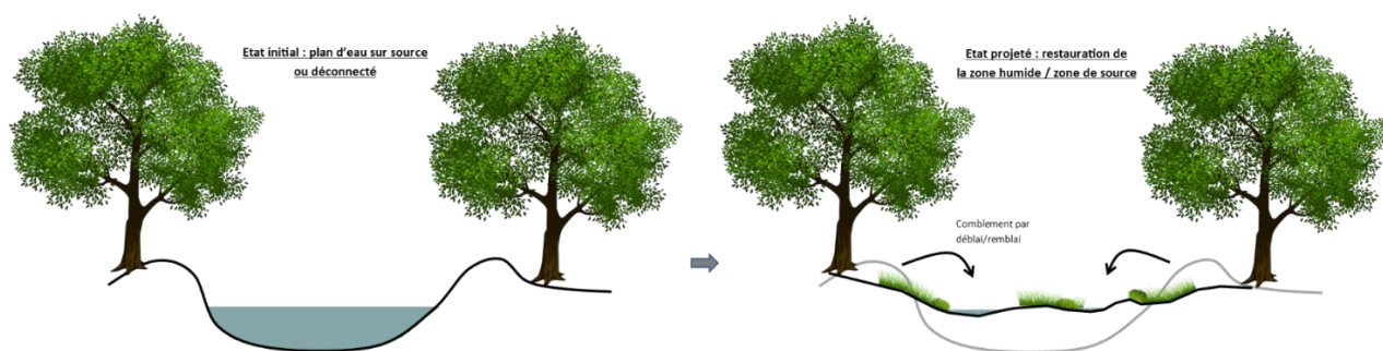
Schéma de principe restauration de zone humide sur plan d'eau sur source ou déconnecté
