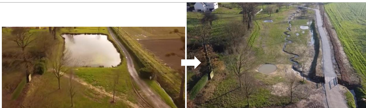
Exemple suppression de plan d'eau sur cours : restauration cours d'eau et zone humide avec création de mares – Source : SMGBO
