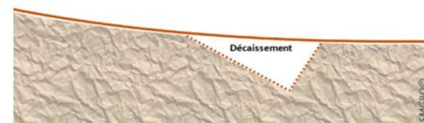
Réalisation du talus : décaissement
