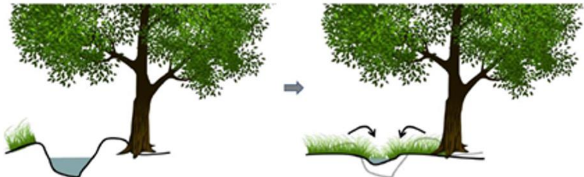
Coupe de principe du rehaussement du rang 0, état initial : rang 0 surcreusé - état projeté : restauration du rang 0
